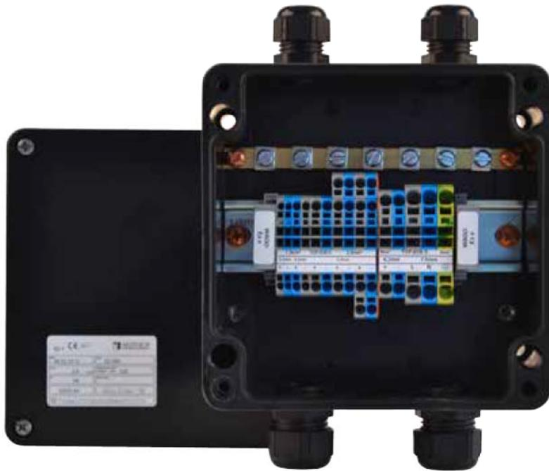
Die MULTI-BOX MBP-Ex e Klemmgehäuse aus Polyester sind nach den neuesten ATEX-Bedingungen zugelassen worden und entsprechen den Anforderungen für Installationsbereiche, in denen explosive Konzentrationen von Gasen, Dämpfen und Stäuben auftreten können. (Zonen 1 und 2, sowie 21 und 22). MBP-Exe-Gehäuse können in den Temperaturklassen T5 bis T6 eingesetzt werden.
