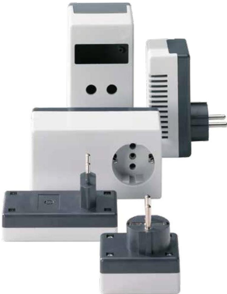
Die zweiteiligen Elektronik-Gehäuse mit verschiedenen Stecker-Ausführungen aus flammwidrigem und schlagzähem Polystyrol werden häufig für Industrie-Netzteile und Ladegeräte genutzt. Wahlweise sind die Steckerteile in Schuko, Europastecker, schweizer und französischer Ausführung erhältlich. Durch Nut- und Federabdichtung wird eine ausgezeichnete Stabilität erreicht und die seitlich geöffneten Unterteile ermöglichen eine schnelle und unkomplizierte Montage von Bauelementen.
