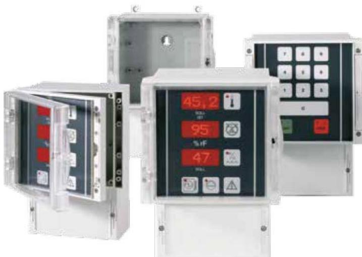
Die neuen Regler-Card-Gehäuse MBRC2 haben einen vergrößerten Anschlussraum und sind in allen Varianten in der Schutzart IP 65 ausgeführt. Ein weiterer Vorteil ist der scharniergelagerte Foliendeckel, der auch mit der Klarsichthaube kombiniert werden kann. Die sechs verschiedenen Deckelvarianten ermöglichen ein großes Anwendungsspektrum im Steuerungsbau und in der Mess- und Regeltechnik. Wahlweise mit oder ohne Vorprägung im Anschlussraum verfügbar.
